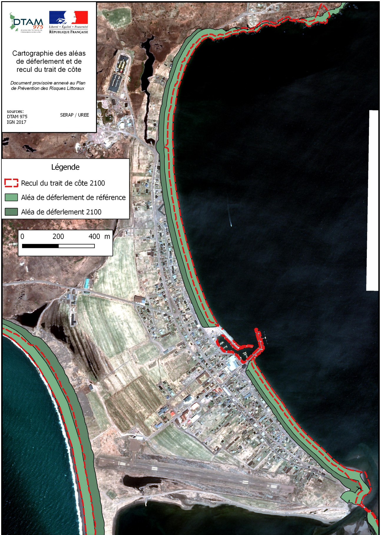
Exemple de carte : aléas de déferlement et de recul du trait de côte
