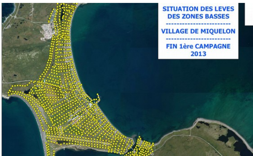
Village de Miquelon : semis de points au GPS avec quadrillage au pas de 50 m réalisé par les agents de la DTAM
